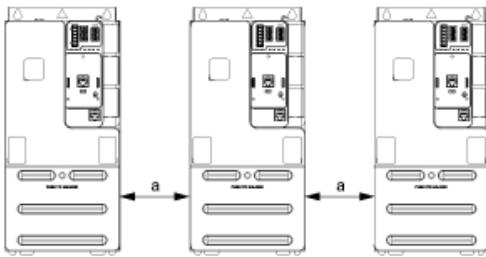
$a \geq 50\text{ mm}$  (1,97 pollici) da 50...60  $^{\circ}\text{C}$ , nessuna restrizione sotto 50 $^{\circ}\text{C}$
