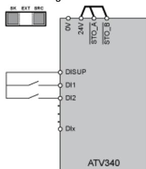
In posizione SRC uscite DISUP 24 V. In posizione SK DISUP connesso a 0 V.
