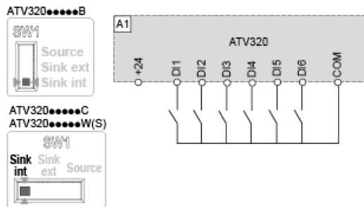
Commutatore SW1 impostato in posizione "Sink Ext" e utilizzo di un'alimentazione esterna per gli ingressi digitali.
