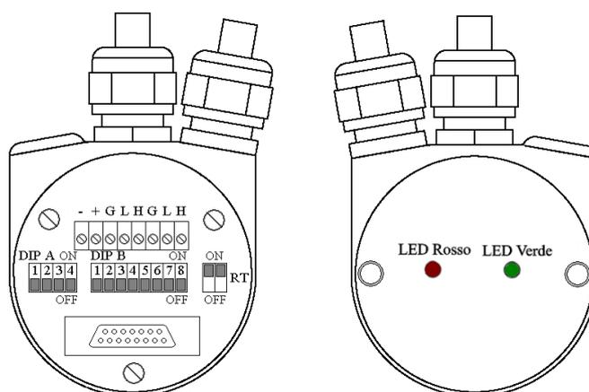
Il coperchio dispone di due pressacavi PG9, per l'ingresso bus, uscita bus e alimentazione. Ciascun cavo si viene a trovare allineato con i relativi morsetti. Per il collegamento del bus si raccomanda di usare l'appropriato cavo certificato CANbus, con sezione massima del conduttore: Ø 1,5 mm.
