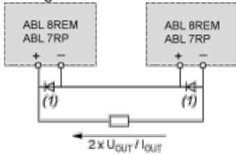
(1) Due diodi Shottky I<sub>min</sub> = alimentatore I<sub>n</sub> e V<sub>min</sub> = 50 V
