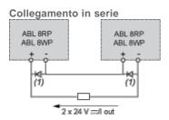
(1) Due diodi Shottky Imin = alimentatore In e Vmin = 50 V
