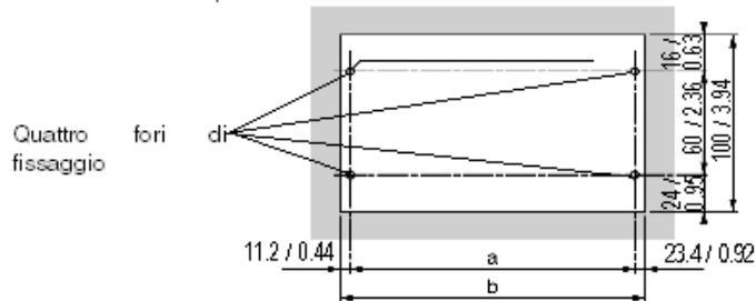
(1) Il diametro dei fori di fissaggio deve consentire l'uso di viti M4, M5, M6 e UNC6.
