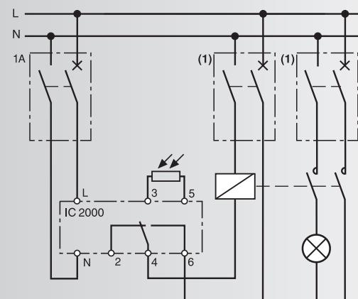
**nl** (1) Bepalen van het kaliber afhankelijk van het vermogen van de ontvanger(s).
