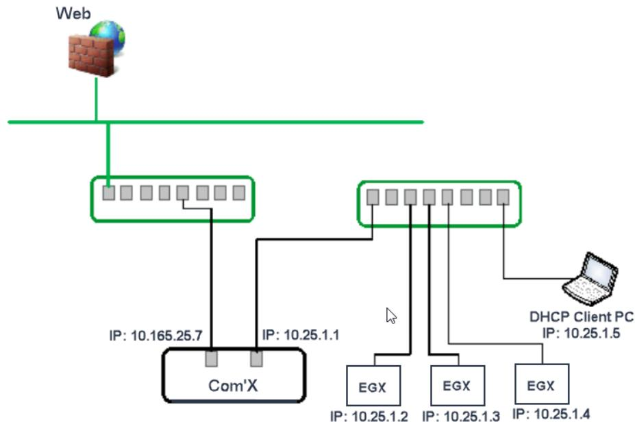
В режиме вышестоящего/нижестоящего устройства два порта Ethernet имеют разные настройки и функционируют независимо:
