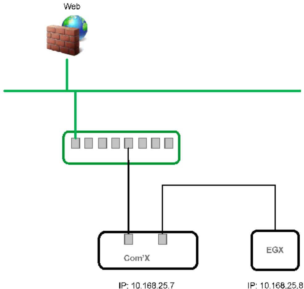
В режиме переключения у обоих портов Ethernet одинаковые настройки. Использование двух портов облегчает монтаж проводки:
