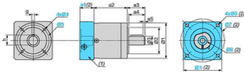
(1) Kit adattatore servomotore
