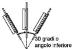
Quando si installa il pannello in posizione obliqua con inclinazione maggiore di  $30^\circ$ , la temperatura ambiente non deve superare  $40^\circ\text{C}$  ( $104^\circ\text{F}$ ). Potrebbe essere necessario l'uso di aria di raffreddamento forzata (ventilatori, A/C) per assicurare che la temperatura ambiente sia al massimo  $40^\circ\text{C}$  (massimo  $104^\circ\text{F}$ ).
