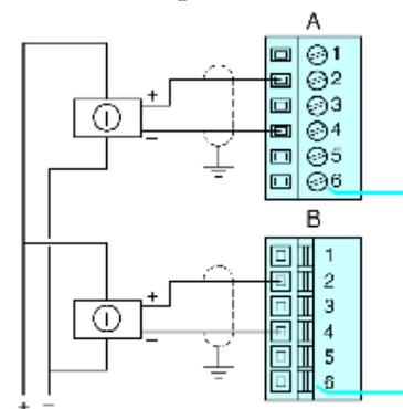
2 sensori analogici non isolati, 24 VCC forniti dal PDM
