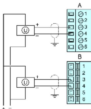
2 sensori analogici non isolati, 24 VCC forniti dal PDM
