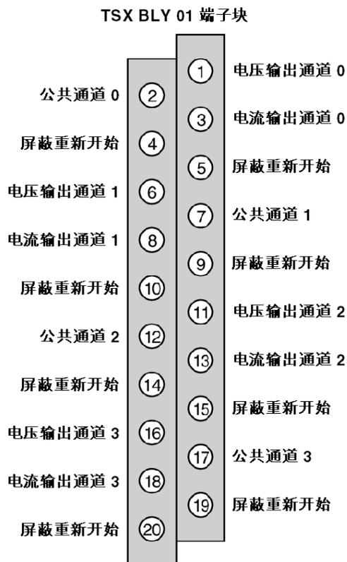
**注意：** 应使用屏蔽电缆，并将其屏蔽层连接到为此提供的端子（重新开始屏蔽）。
