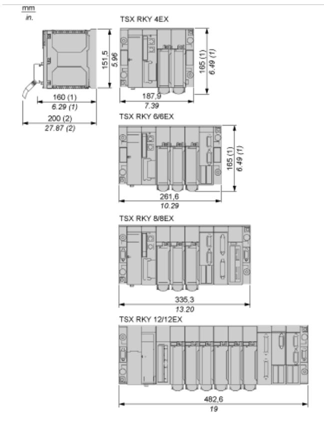
(1) Con moduli blocco morsetti a vite.
