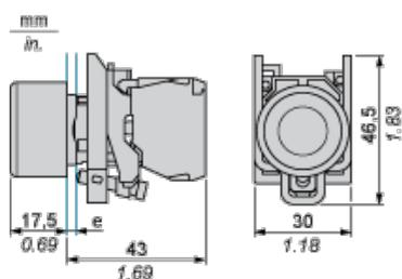
e: spessore fissaggio: da 1 a 6 mm / da 0,04 a 0,24 in.
