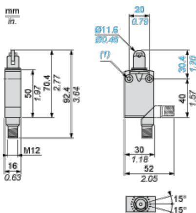
(1) 2 fori di fissaggio  $\varnothing$  4,2 mm, incasso  $\varnothing$  8 mm e 4 mm di profondità
