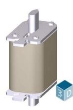
SITOR fuse link, with blade contacts, NH00, In: 35 A, gR, Un AC: 690 V, Un DC: 440 V, front indicator
