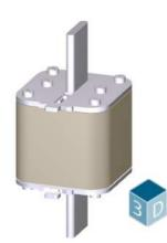
SITOR fuse link, with blade contacts, NH3, In: 850 A, gR, Un AC: 690 V, front indicator
