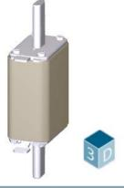
SITOR fuse link, with blade contacts, NH0, In: 125 A, aR, Un AC: 1000 V, Un DC: 440 V, front indicator
