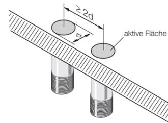
**Nichtbündig einbaubare Näherungsschalter**
