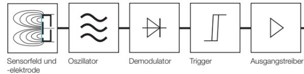
Nähern sich Gegenstände aus Metall oder Nichtmetall der aktiven Fläche des kapazitiven Sensors erhöht sich die Kapazität des offenen Plattenkondensators und der Oszillator beginnt zu schwingen. Dadurch kippt die, dem Oszillator nachgeschaltete Triggerstufe und der Schaltverstärker ändert seinen Ausgangszustand. Die Funktion des kapazitiven Sensors lässt sich an der Gleichung für die Kapazität eines Plattenkondensators erklären:
