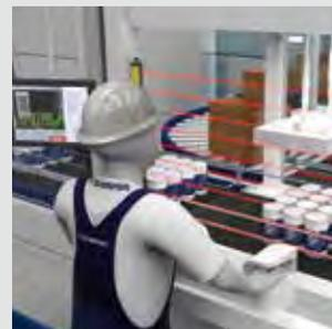
Los equipos cumplen con las exigencias de la norma EN 574, que, entre otros determina la distancia entre los dispositivos de mando. El usuario puede elegir entre varias versiones, que se distinguen, entre otros, por el material de la caja (plástico o fundición inyectada de aluminio). En la parte central de las cajas plegables se pueden montar hasta ocho dispositivos de mando y señalización adicionales.
