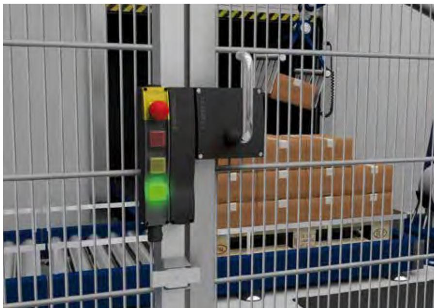
La imagen muestra la combinación con el BDF 200 y un dispositivo de bloqueo por solenoide AZM 200, incluyendo el actuador de manilla B30 con el grupo de montaje como elegante solución para un resguardo de seguridad móvil.
