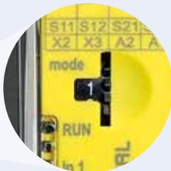
L'impostazione della funzione avviene tramite l'interruttore rotativo "mode".
