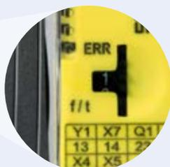
La fréquence seuil et la temporisation à l'enclenchement/au démarrage sont configurées au moyen de la molette „f / t“.
