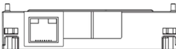
Connexion à des modules Ethernet ou BACnet fonctionnant avec le connecteur RJ45.
