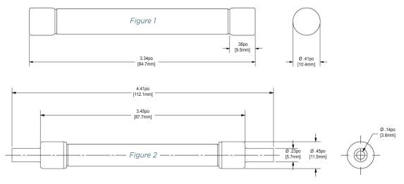
Borne CC (Fig. 2): Outil de sertissage recommandé: T & B Sta-Kon ERG4002 #10 -12 AWG (6-4 mm²)
