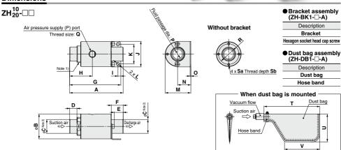
Ε G М N Р Q R Sa U ٧ øΒ øC D F н Κ Т ZH10-73 34 19 10 12.2 16.2 69.8 31 35 27 35 18 13 Rc1/8 28 M3 x 0.5 5 300 150 190 4.5 ZH20-□□ 119.5 55 15 18.5 23.5 48 56 48 56.5 29 21.6 Rc1/4 44 M4 x 0.7 200 32 111 8 250
